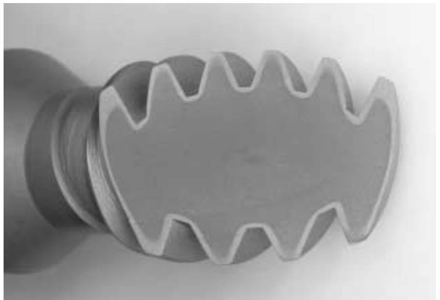
Bild 5: Schrägschliff einer im Eldec-SDF-Verfahren gehärteten Schneckenwelle mit einem Durchmesser von 32,6 mm. Eingesetzte Leistung 400 kW MF + 166 kW HF bei einer Heizzeit von 0,35 s Figure 5: Diagonal microstion of a worm shaft hardened with the Eldec SDF-method with a diameter of 32.6 mm. Power input 400 kW MF + 166 kW HF at a heating time of 0.35 s
