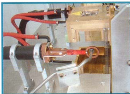
Bild 8. Weit geöffnete Schutzkammer mit Ringinduktor und eingeschobenem Rohrwerkstück.
