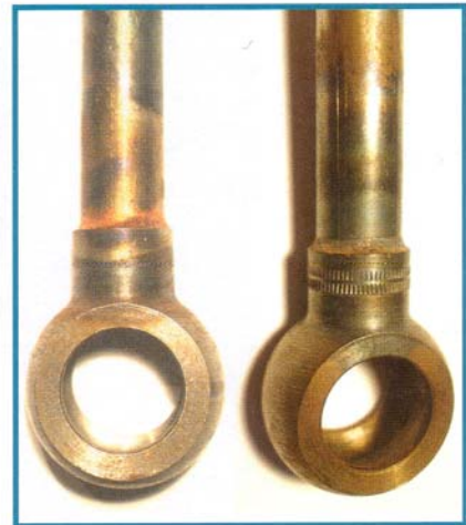
Bild 6. Induktiv im SG gelötete Ringstücke \varnothing 12 \times 1 mm; links Abkühlung 1 Min. unter SG, rechts ohne Abkühlung im SG.
