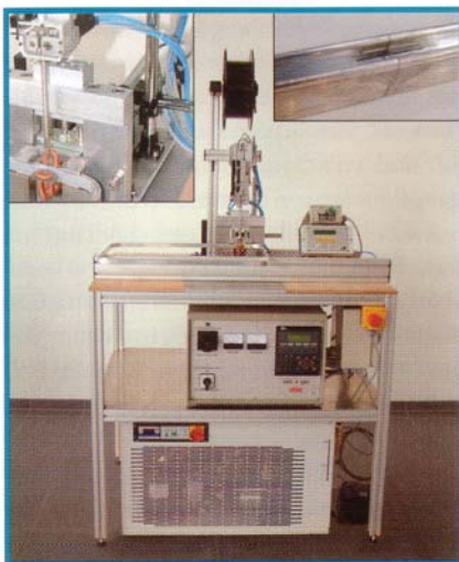
Bild 12. Hartlöten von Aluminiumprofilen mit Gabelinduktor und Lotdrahtvorschub; links oben Detail mit Induktor und Lotdrahtvorschubgerät, rechts oben das gelötete Alu-Profil.
