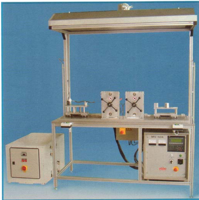
Bild 7. Lötanlage mit zwei im Wechseltakt arbeitenden Schutzgaslötvorrichtungen, gespeist von einem MFG 15 DA.
