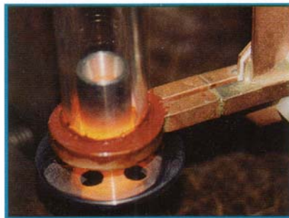
Bild 5. Schutzgaslöten innerhalb eines Glasrohrs, das mit dem einwindigen Induktor verklebt ist.
