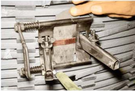
▲ Bild 2: Vorbereiten der Lötstelle mittels einer kleinen Spannvorrichtung. Die Kupferdrähte werden auf Stoß ausgerichtet und die Lotfolie zwischen die Drahtenden geklemmt
