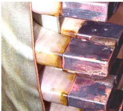
▲ Bild 6: Mit hoher Leistungsdichte (eldec MFG 50) induktiv gelötete massive Kupferleiter eines Schleifringläufers. Die bis an die Lötstelle herangeführte Bandisolierung ist thermisch nur geringfügig in Mitleidenschaft gezogen worden. Gesamtquerschnitt der Lötverbindung ca. 650qmm. Lötzeit ca. 30s
