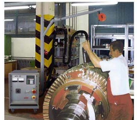
▲ Bild 5: Löten von Kupferverbindungen an einem Schleifringläufer. Links unten im Bild die Induktionserwärmungsanlage eldec MFG 50, dahinter eine bewegliche Kabelaufnahme (Galgen) mit Balancer, an dem das Werkzeug (Lötinduktor mit Koaxtrafo) hängt. Nach Vorbereitung der Lötstelle wird der isolierte Lötinduktor auf die zu lötenden Kupferleitungen gedrückt und durch Auslösen des Startimpulses am Koaxtrafo der Lötprozess gestartet
